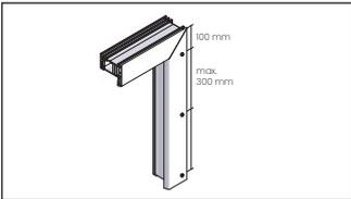
**6** Die ersten Klemmnippel von oben und unten ca. 100 mm von Außenkante Blendrahmen und alle Weiteren mit einem Abstand von max. 300 mm anschrauben.
