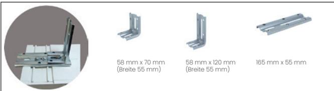
**Montagewinkel/ -schiene** (bauseits): zur Befestigung am Baukörper können mit der Gewindeplatte mittels Schrauben M6/12mm (DIN EN ISO 4017) verschraubt werden. Im Beispiel Montageschiene/ -winkel von der Firma Würth.
