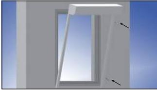
**10** Richten Sie den Rollladenkasten aus und verschrauben Sie ihn durch die dafür vorgesehenen Bohrlöcher in den Führungsschienen mit der Wand.
