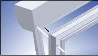
**9** Montieren Sie den Rollladenkasten. Hierzu halten Sie den Rollladenkasten inklusive Rollladenführungsschienen an die richtige Position am Fenster und fädeln Gurt, Kurbelstange oder Motorkabel durch die Durchführungsbohrung.
