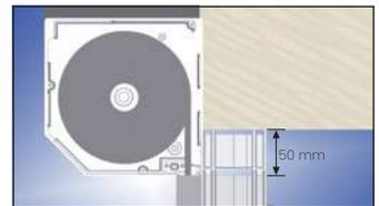
**6** Bohren Sie die Durchführungen für Gurt-, Kurbel- oder Motor-Antrieb durch das Mauerwerk bzw. den Blendrahmen. Das Maß von Außenkante Rollladenkasten bis Mitte Gurt und Kurbelstift beträgt 16 mm.
