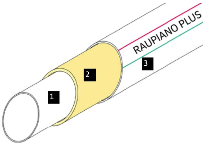
Der 3-schichtige Aufbau von RAUPIANO PLUS führt zu einer erhöhten Rohrsteifigkeit. Nummer 1 zeigt eine abriebfeste und hochgleitfähige Innenschicht aus PP. Nummer 2 besteht aus einer hochsteifen Mittelschicht aus mineralverstärktem PP und Nummer 3 ist eine schlagzähe und stoßfeste PP-Außenschicht. Für die Verwendung des Produkts gelten die jeweiligen nationalen Bestimmungen am Ort der Verwendung.
