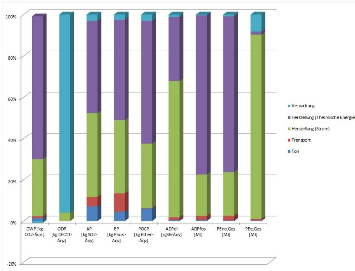
Die Auswertung der ökobilanziellen Ergebnisse der Dachziegel zeigt auf, dass die Umweltwirkungen in allen Umweltkategorien speziell vom Energieverbrauch während des Herstellungsprozesses (Strom und thermische Energie aus Erdgas) im Werk dominiert werden.
