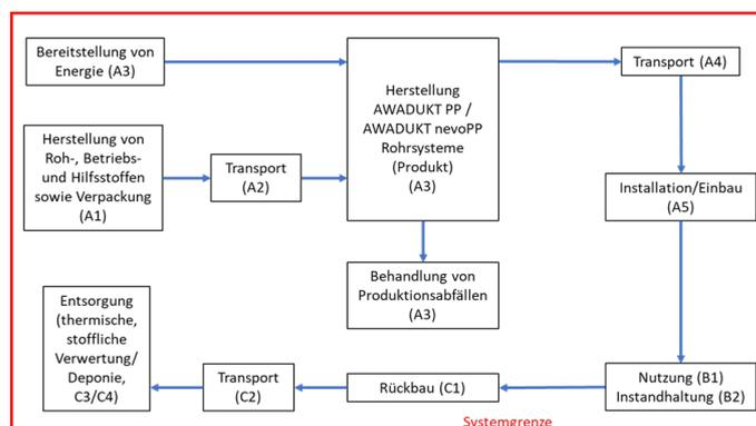
Im Folgenden sind die berücksichtigten Lebenswegabschnitte bzw. Prozessmodule für die Herstellung der Rohrsysteme detailliert aufgelistet:
